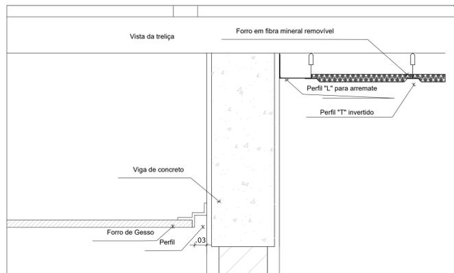
2 DETALHE 1: NEGATIVO E FIXAÇÃO FORRO MINERAL
